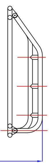
El largo del ponton se deberá adaptar de acuerdo al entre ejes del automóvil, respetando la separación máxima acotada respecto de los neumáticos.
