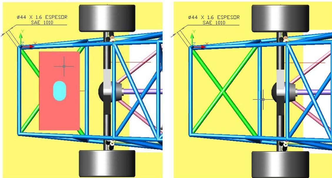
**INC.5:** El depósito de combustible deberá tener un “container” como protección adicional de acuerdo a como especifica el fabricante respetando las dimensiones y material, el mismo debe ser de chapa de acero laminada en frio 20 gauge (1mm) mínimo de espesor u opcionalmente aluminio con un espesor mínimo de 0.063” (1.6 mm), dicho contenedor deberá estar libre de rebabas, o filos cortantes en su interior. Esta absolutamente prohibido todo tipo de modificación que no este
