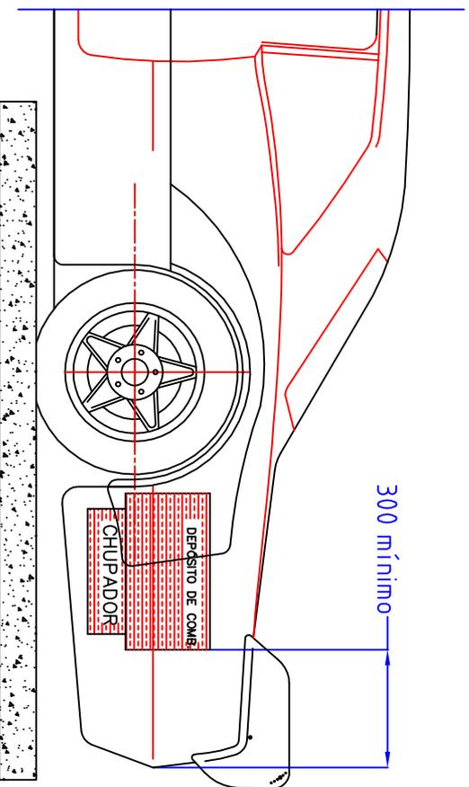
La fijación del depósito de combustible en relación a la altura del mismo es libre con la condición que él mismo como todos sus accesorios (chupador) estén en el interior del vano baúl.
