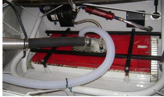
La manguera de venteo deberá salir perpendicular al tanque de combustible y el giro de la misma deberá hacerse lo más próximo a la tapa de baúl a fin que evitar derrames de combustible con tanque lleno.
