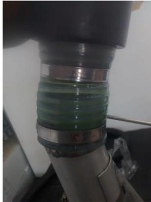
3. **PROLONGACION DE ALUMINIO:** deberá ser un caño de aluminio de 60 mm de diámetro y 1,5 mm de espesor. Largo máximo 440 mm.
