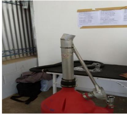
6. **MANGUERA FLEXIBLE DE VENDEO:** deberá ser apta para hidrocarburos. Sera de 1 ½” de diámetro comercial con un espesor de 5 mm y un largo máximo de 1650 mm. Deberá apretarse con una abrazadera 32-50 en el caño de venteo de la mamadera.
